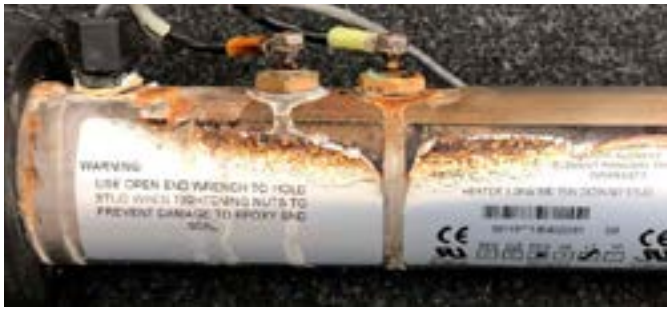
Eroderet varmelegeme med tærede pakninger.
